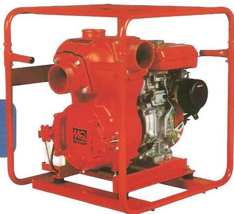
QP-40TA 4" x 4" Robin de 11 HP. Encendido eléctrico y retráctil. Hasta 611 Gls/min. Pasa sólidos máximo 2" Ø.
